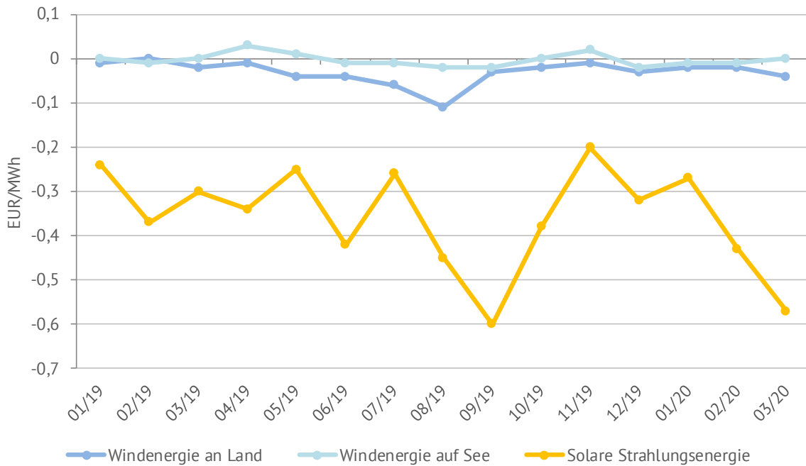
Abbildung 3: Durchschnittliche Kosten der 15-min Glattstellung am Intraday-Markt [eigene Berechnung nach EPEX Spot und ENTSO-E]
